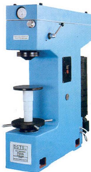
Macchina motorizzata a comando idraulico regolabile per l'applicazione del carico. Un comparatore legge la profondità di penetrazione della sfera per facilitare al massimo operazioni di controllo ripetitive comparative. Lettura dell'impronta tramite MICROSCOPIO CENTESIMALE.
