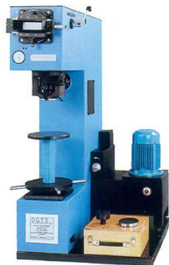
Macchina simile al modello "H", ma munita di un visore ottico a 14 ingrandimenti per la misurazione diretta dell'impronta della sfera con tolleranza centesimale. La lettura è eseguibile immediatamente dopo l'operazione di penetrazione; senza alcuna perdita di tempo. Applicabile un lettore digitale dell'impronta.
