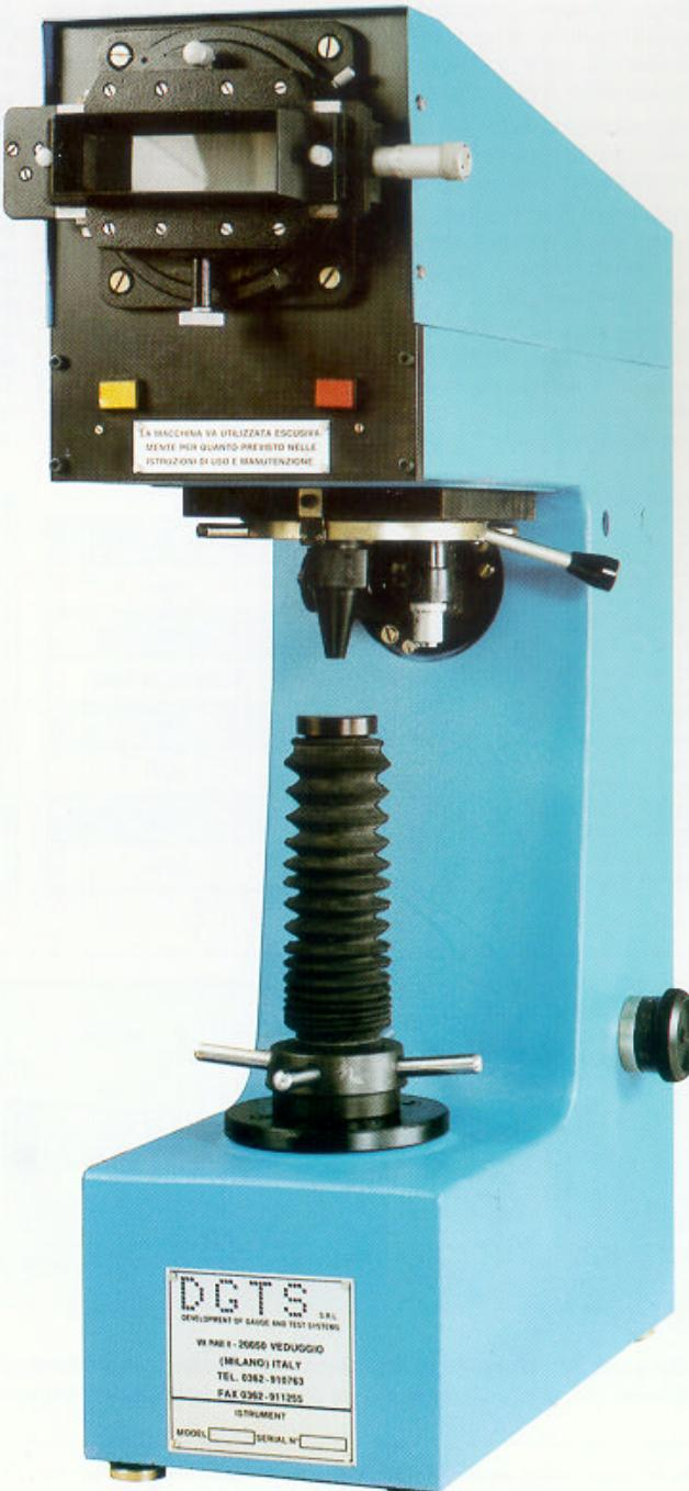
Il durometro DGTS modello VM50 è dedicato alla misurazione di durezze secondo il metodo VICKERS che utilizza penetratore di diamante a forma piramidale e carichi non elevati.
